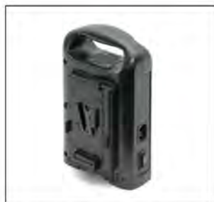
V型鋰電池充電器 (兩充) BC-2ES (可當電源供應器使用) 輸入: AV90~240V 47~63Hz 輸出1/2: DC16.8V 2.6A 輸出3: DC15V 4A
