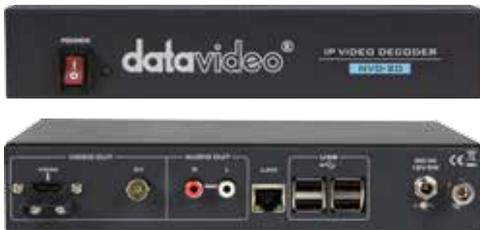
運用編碼器將影像訊號利用網路傳輸，是目前多數電視台傳遞節目影像所使用的方式，尤其是地方性電視台向頻道系統商購置時段性節目，就是利用網路直接將直播影像即時傳輸播出，所以編、解碼設備就是最主要傳輸的主要工具。NVD-20 專為網路直播後端接收的解碼設備，可將網路傳輸的訊號，轉換成 HDMI、Composite 和類比聲音輸出。NVD-20 可相容解碼播出的 IP 格式有 RTP/RTSP、RTMP、UDP、TCP、HTTP 和 MPEG-TS 等，涵蓋絕大部分的網路 IP 格式。
